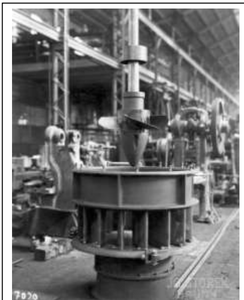
Základní součásti Kaplanova vynálezu – oběžné kolo s natáčecími lopatkami, rozváděcí kolo. Firma Ignác Storek, dvacátá či třicátá léta 20. století (Technické muzeum v Brně)
